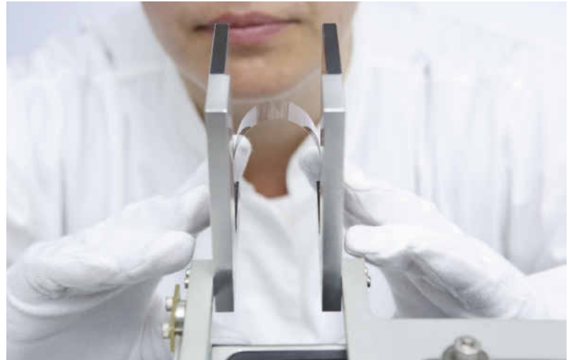
Ein Handy zum Knicken: Mit dem Modell „Galaxy Z Flip“ hat der südkoreanische Hersteller Samsung ein Smartphone mit biegsamem Bildschirm auf den Markt gebracht (links). Die Grundlage dafür ist ein neuartiges Glas, das sich falten und wieder gerade drücken lässt, ohne Schaden zu nehmen. Entwickelt wurde die gläserne Folie, die etwa so dünn ist wie ein menschliches Haar, in den Forschungslabors des Mainzer Unternehmens Schott (oben).
